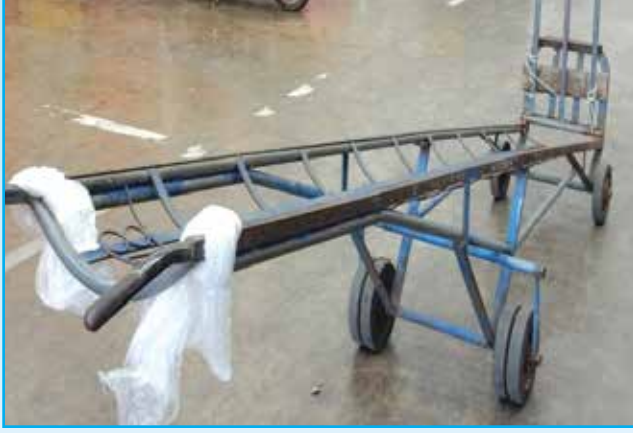
চিত্র-১৭. পণ্যভর্তি প্লাস্টিক ক্রেটস স্থানান্তরের জন্য উপযুক্ত হ্যান্ড ট্রলি
